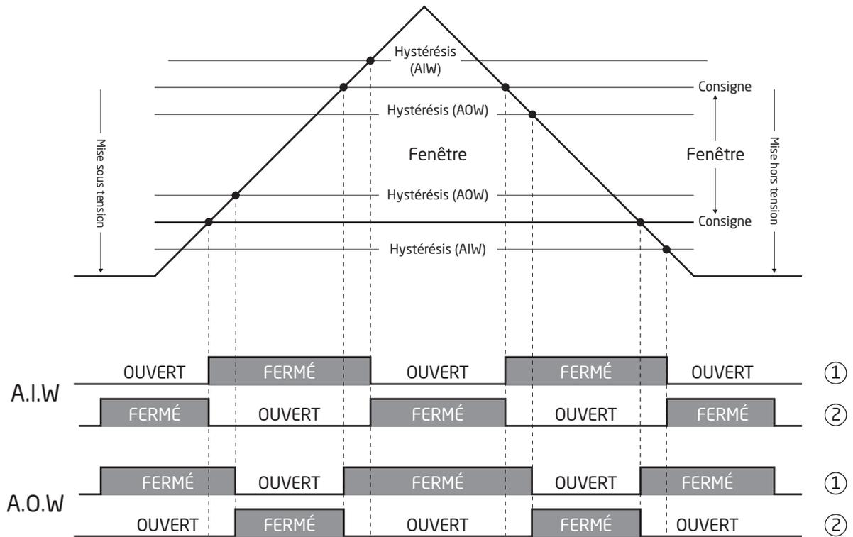
Fonction du relais : Actif à l'intérieur de la fenêtre / Actif à l'extérieur de la fenêtre
