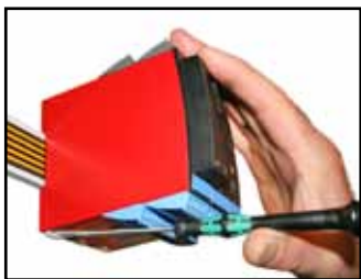
Figure 1 : Débloquez le verrou inférieur pour dégager le module du rail d'alimentation.
