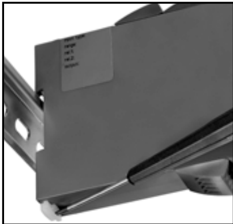
Figure 1: Séparation du module et du rail DIN.
