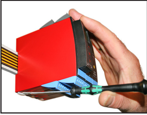
图 1： 通过提起底部锁定装置，可将设备从 DIN 导轨上拆下。
